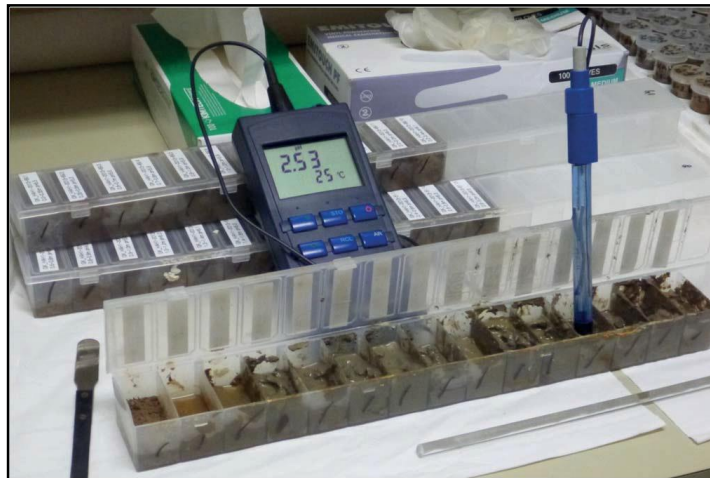
Figur 2. Inkubation av jordprov i så kallad chip tray. Foto: Pentti Kouri, GTK.
